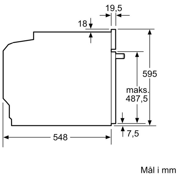
Hvis apparatet bygges ind under en kogesektion, skal følgende bordplade-tykkelse (i givet fald inkl. underkonstruktion) overholdes.
