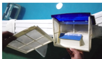
5. Trekk filteret ut vannrett
