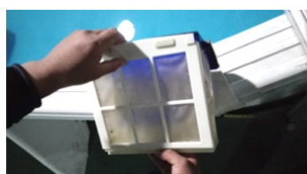
4. Løft filtret ca. 2 centimeter op fra filterbakken
